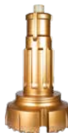
SD 12 Ø 305 mm Face Semi côncava Botões Esféricos 15*19mm / 15*19mm / 12*16mm
