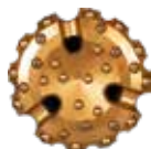
M 85 Ø 203 mm Face Semi côncava Botões Esféricos 10*19mm / 8*18mm / 8*16mm
