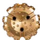
M 85 Ø 286 mm Face Semi côncava Botões Esféricos 12*19mm / 9*19mm 6*18mm / 9*16mm
